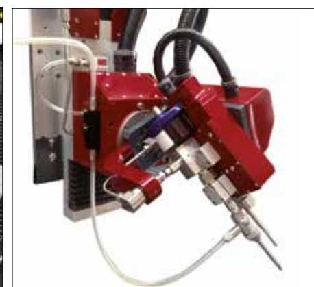
Edge 5 axis ±55° interpolating system up to 4.150 Bar with I.T.C.™ (Intelligent Tapering Control) Sistema Edge a 5 assi interpolanti ±55° fino a 4.150 Bar con I.T.C.™ (Compensazione Conicità)
