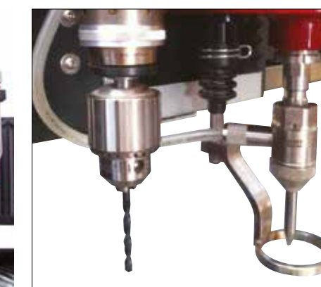
Pre-drilling cnc mechanical system Sistema di preforo meccanico o per bisellatura fori
