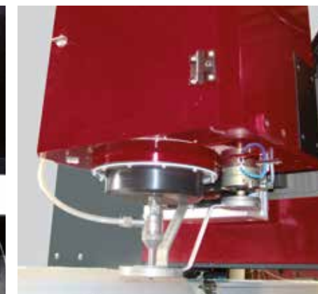
I.T.C.™ - Intelligent Tapering Control system with self positioning touch probe and anticollision device Sistema a 4 assi per la compensazione della conicità I.T.C.™ (Intelligent Tapering Control) con tastatore e sistema anticollisione
