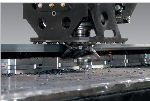
Beveling with CBM® Detalle de biselado con CBM®
