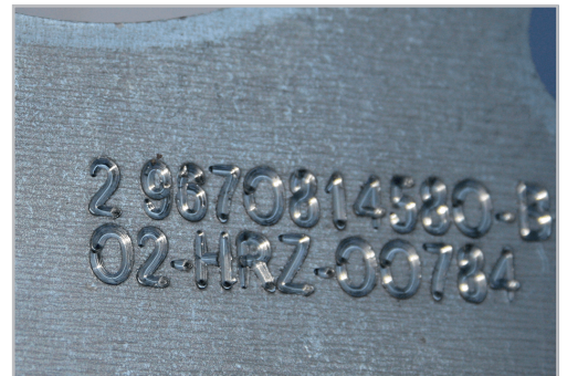
Part marking Detalle marcado de piezas
